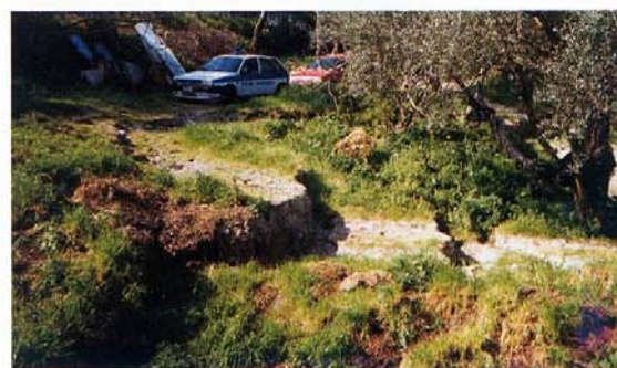
Fig. 15 - Scorrimento rotazionale multiplo in coltri alterate di flysch miocenico (loc. Montebosco - Piano).
