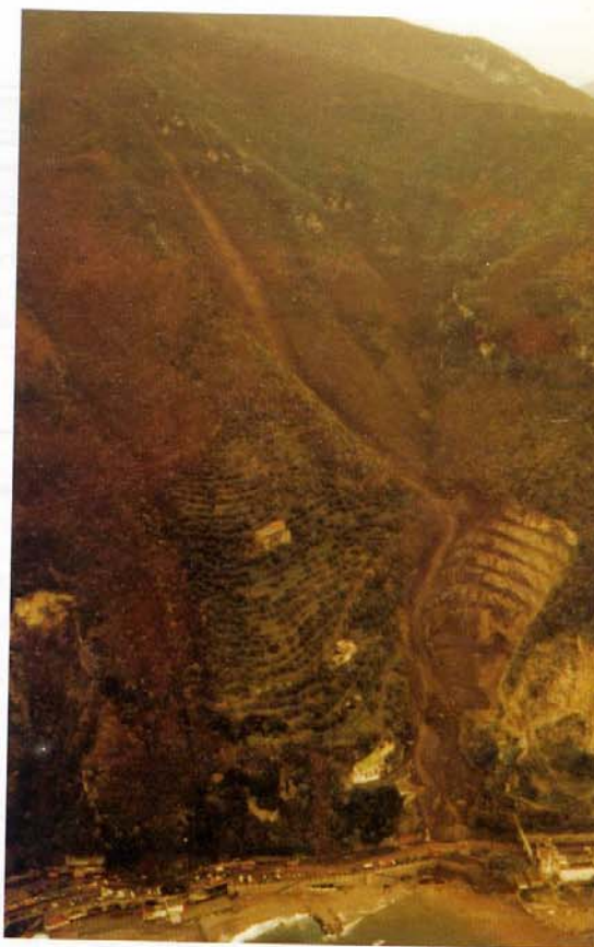
Fig. 12 - Lo scorrimento traslativo - colata rapida di terra di Pozzano (Castellammare di Stabia) [foto di G. Lombardi].
