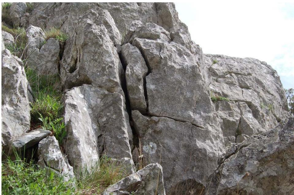
*Fig. 2.9. Instabilità di tipo 5 (spinta nella frattura a tergo e riduzione dell'appoggio al piede).*
