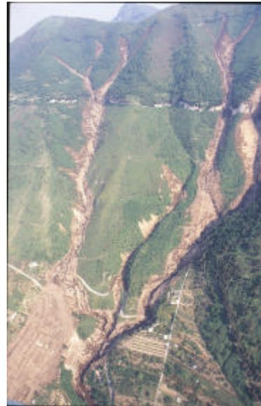
Fig. 20 - Esempio di frana non incanalata “sub triangolare” con alto valore (29°) dell’angolo di Reach (frana di Nocera del marzo 2005 a destra) ed esempio di alcune colate “incanalate” di Sarno del maggio 1998 con basso valore dell’angolo di Reach (15°).
